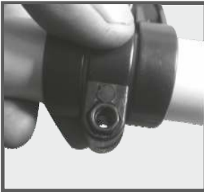
19. Закрутите черную гайку М5 в держатель ремня.
