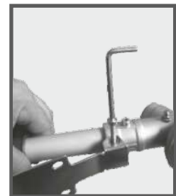
28. Плотно закрутите болт М5х35.
